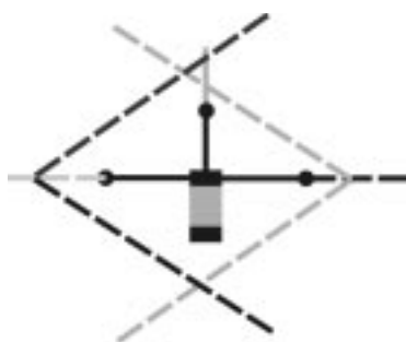
Рис. 8. «Оттяжка» проводников за межслойные переходы
