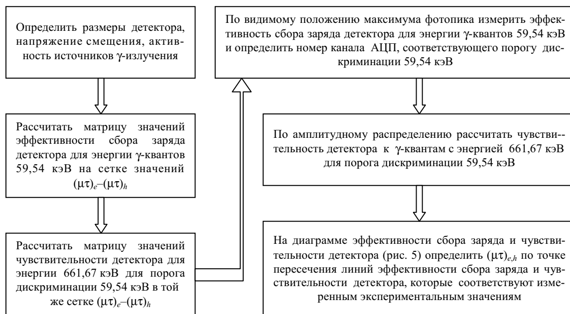
Рис. 3. Алгоритм расчета (\mu\tau)_{e,h}
