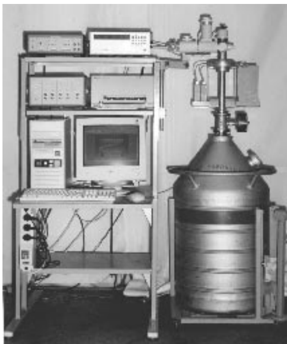
Рис. 3. Экспериментальная установка частотомера-спектроанализатора с использованием перехода Джозефсона
