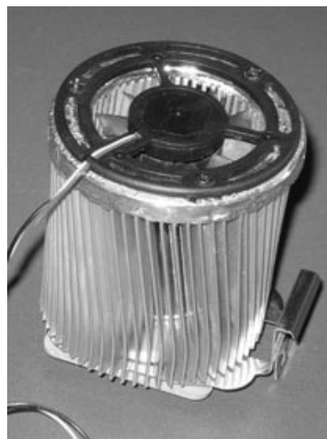
Рис. 1. Внешний вид кулера с металлическим кольцом на концах ребер
