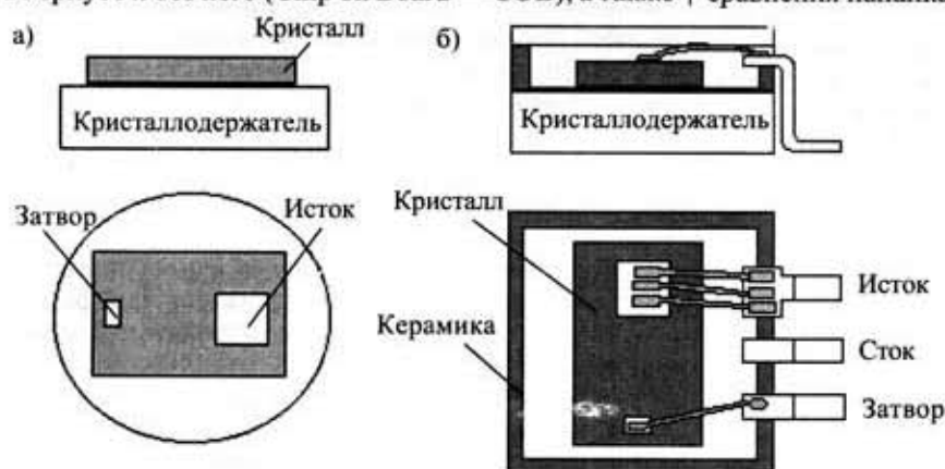
Рис. 1. Мощный MOSFET-транзистор в бескорпусном исполнении: а — на безвыводном металлическом держателе; б — с внешними выводами на металло-керамическом или керамическом держателе
