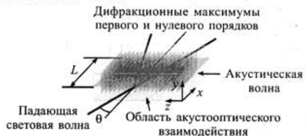
Рис. 1. Дифракция света на акустической волне
