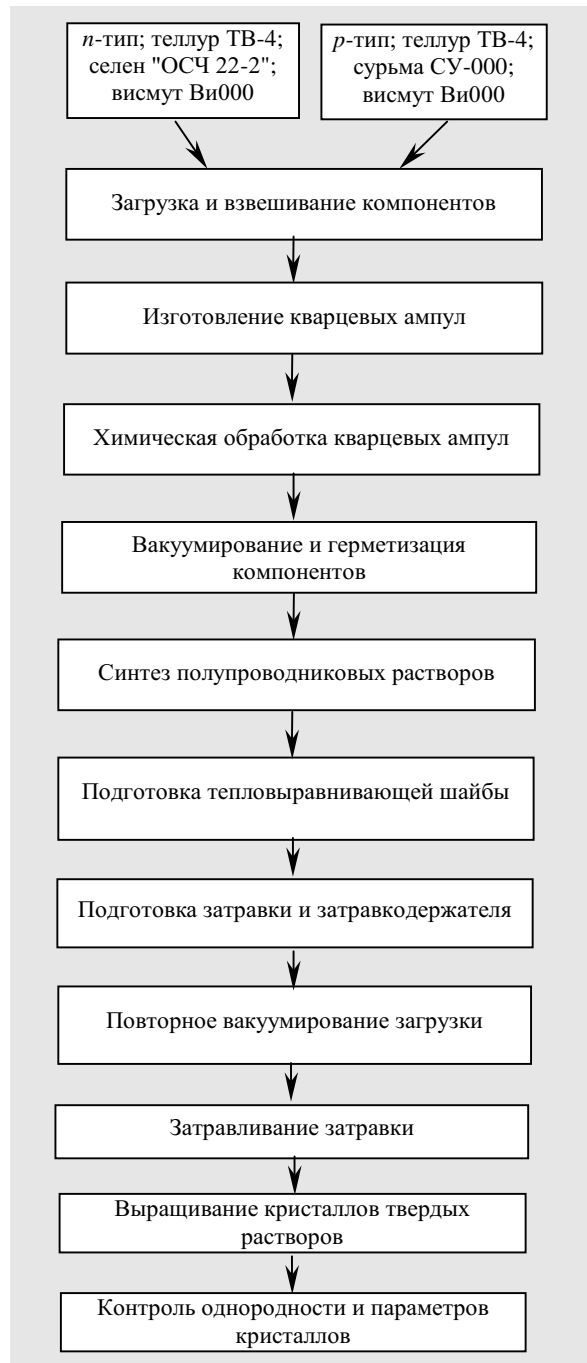
Рис. 3. Схема технологического процесса получения однородных термоэлектрических материалов на основе кристаллов твердых растворов Bi–Te–Se–Sb
