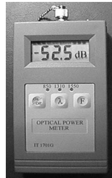
Рис. 5 Конструктивно измеритель средней мощности оптического излучения IT1701 (рис. 5) выполнен в противоударном пластиковом корпусе и помещен в защитный кожаный чехол. Основные технические параметры приведены в табл. 1.
