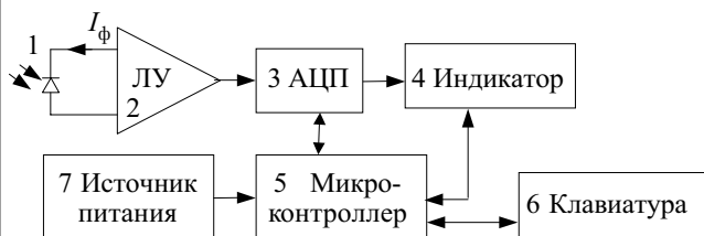
Рис. 1. Функциональная блок-схема прибора ( I_\phi — ток фотодиода)
