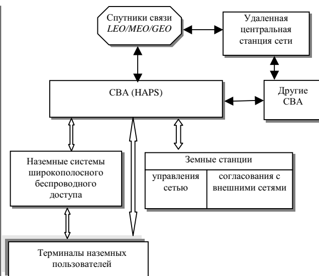
Рис. 2. Структурная схема одной соты ТСВА
