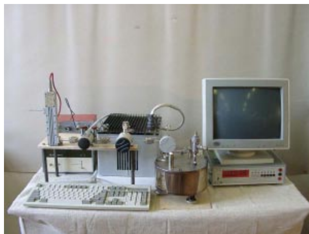
Рис. 2. Многоканальная измерительная система для калибровки высокотемпературных генераторов шума
