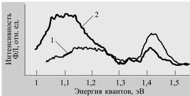
Рис. 6. Спектры ФЛ структур InAs—GaAs, выращенных при 400°C (1) и 500°C (2)
