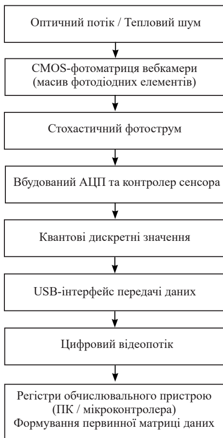
Рис. 1. Структурна схема апаратно-програмного тракту генерації послідовностей випадкових чисел
