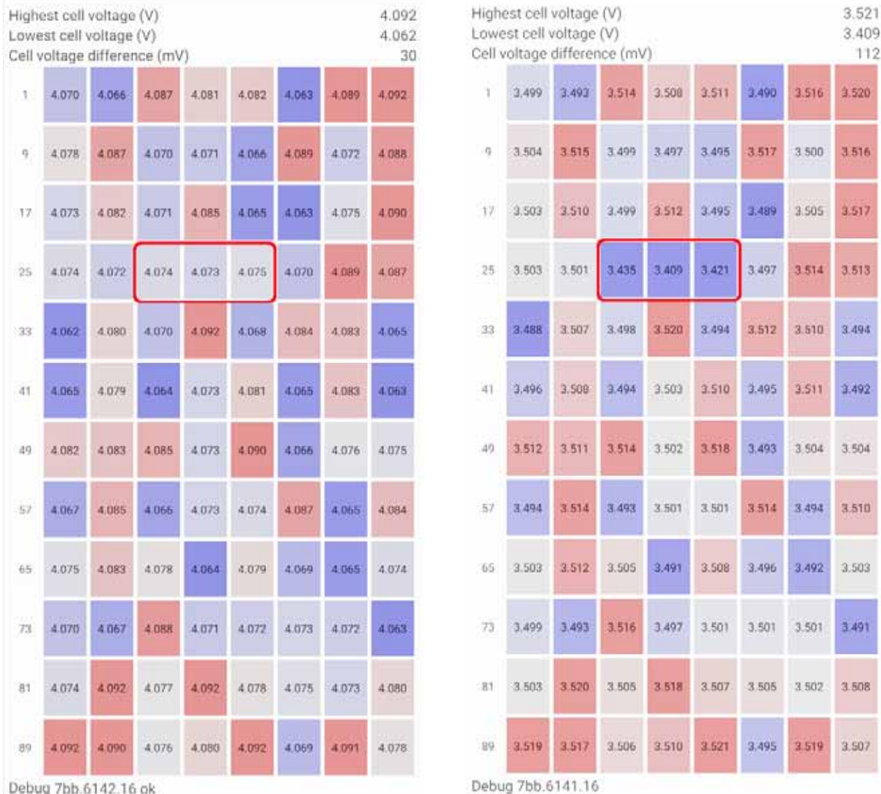
Рис. 4. Мапа комірок зарядженої (ліворуч) та розрядженої (праворуч) батареї з активним балансиrom
