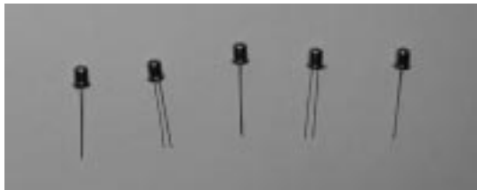
Рис. 2. Образцы интегральных сенсоров влажности
