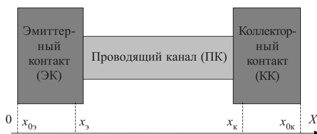
Рис. 1. Квантовый провод, состоящий из эмиттерного и коллекторного контактов и проводящего канала
