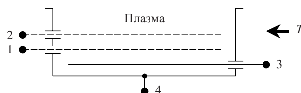
Рис. 1. Конструкция преобразователя параметров плазмы типа зонда с запирающим потенциалом: 1 — супрессорная сетка; 2 — управляющая сетка; 3 — коллектор; 4 — корпус ППП
