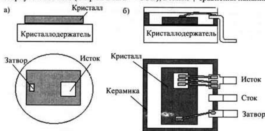
Рис. 1. Мощный MOSFET-транзистор в бескорпусном исполнении:
