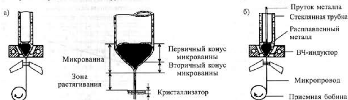
Рис. 1. Получение литого микропровода в стеклянной изоляции из жидкой фазы металлов и сплавов по методу Улитовского капельным (а) и непрерывным (б) способами
