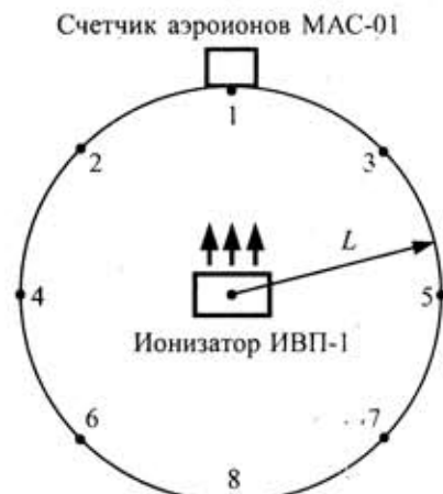
Рис. 2. Схема измерения концентрации отрицательных ионов для разной удаленности ионизатора L и его направленности
