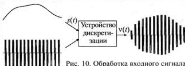
Рис. 10. Обработка входного сигнала
