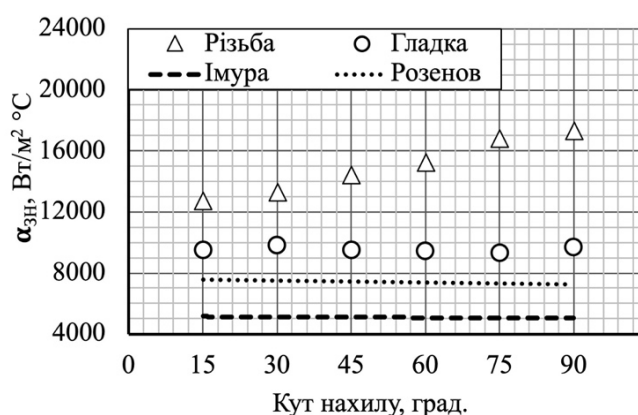
Рис. 2. Експериментальні залежності коефіцієнта тепловіддачі \alpha_{\text{нп}} в зоні нагріву від кута нахилу ГРТТ з різьбовою та гладкою поверхнями при підведенні теплової потужності 50 Вт, а також відомі залежності Імура та Розенова, розраховані за формулами з [2]
