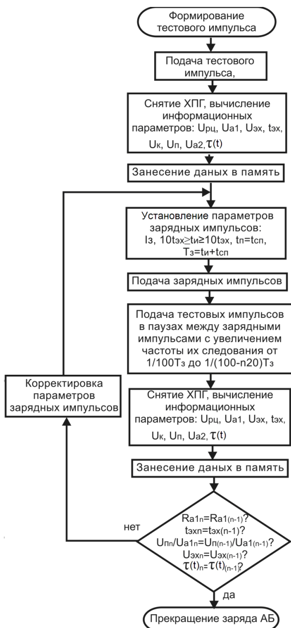
Рис. 2. Блок-схема алгоритма управления процессом зарядки НЭ (ХПГ — хронопотенциограмма)
