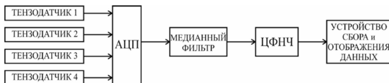
Рис. 1. Структурная схема системы для взвешивания подвижных составов с медианным фильтром
