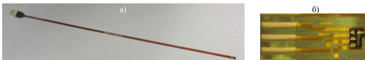
Рис. 2. Зонд с MOSkin-детектором на конце тонкого шлейфа с токопроводящими шинами длиной 40 см, шириной 2,5 мм [2] (а) и фото сборки кристалла MOSkin-детектора на гибком носителе (б) [3]
