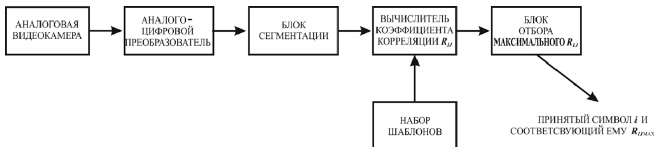
Рис. 1. Структурная схема системы оптического распознавания шаблонов радиокомпонентов на печатных платах
