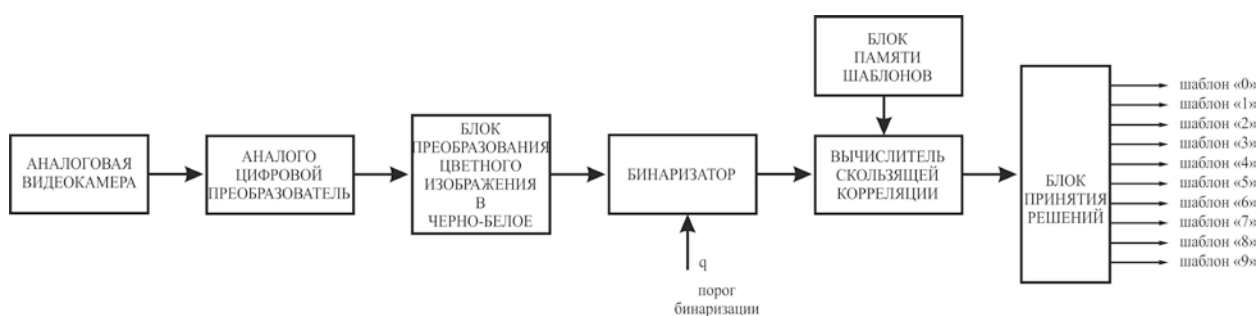
Рис. 2. Структурная схема системы оптической диагностики печатных плат
