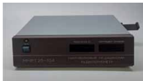
Рис. 4. Блок-схема та зовнішній вигляд створеного на НВП «Сатурн» радіотермографа:
