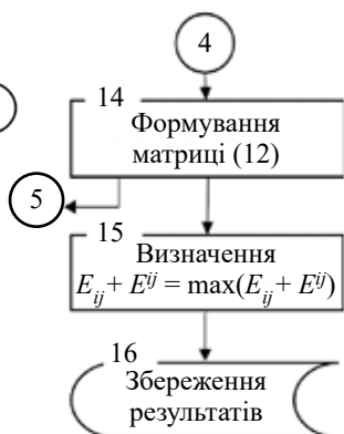
Рис. 3. Блок-схема алгоритма оптимізації розташування СБ в двох положеннях
