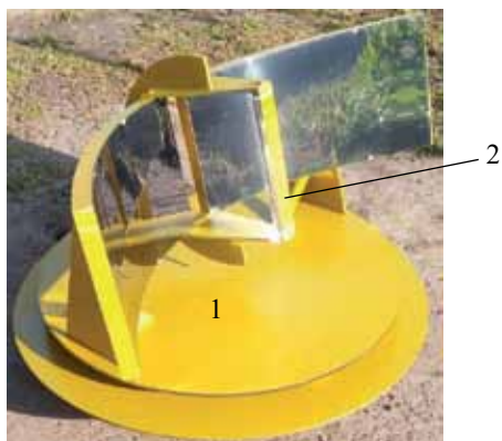
Рис. 1. Концентраторна геліоенергетична установка (1) з місцем для встановлення фотоенергетичного модуля (2)
