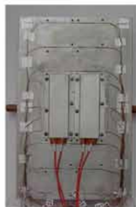
Робоча ділянка з центральним розташуванням нагрівача на основі радіатора
