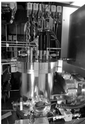
Рис. 1. Установка МОС-гидридной эпитаксии Discovery 180 LDM
