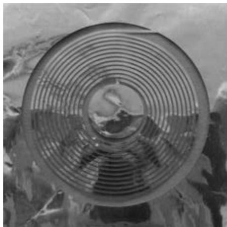
Рис. 1. Акустическая мембрана ВЧ-излучателя на полиимидной основе
