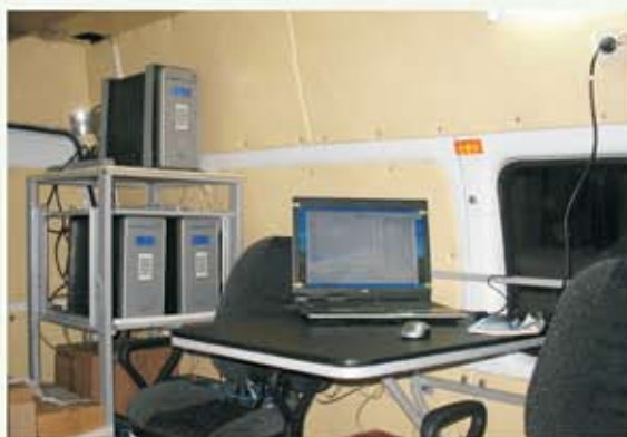
Автоматическая система экологического мони- торинга атмосферы, смонтированная внутри передвижной экологической лаборатории
