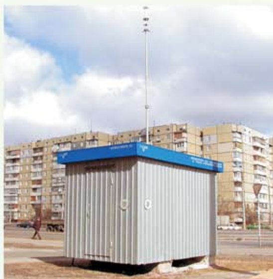
Автоматизированный пост наблюдений за состоянием атмосферного воздуха АТМОСФЕРА-10
