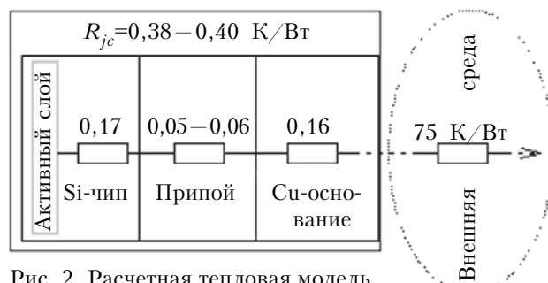
Рис. 2. Расчетная тепловая модель теплового сопротивления транзистора КП723Г
