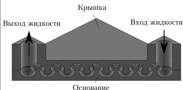
Рис. 3. 3D-модель теплообменника (симметричная половина)
