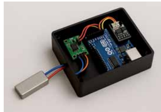
Рис. 3. Блок-схема системи з сенсором на основі ниткоподібних кристалів кремнію (а) та фотографія готового пристрою (б)
