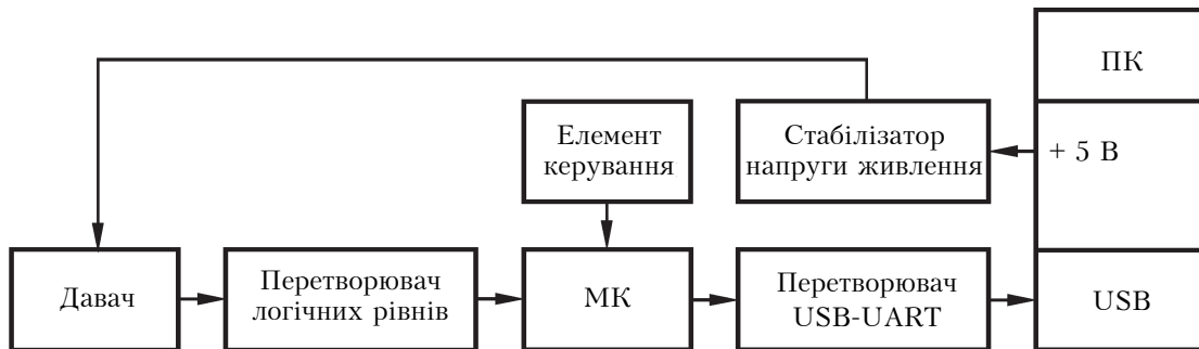
Рис. 8. Структура системи вимірювання мікропереміщень на основі MEMS-давача
