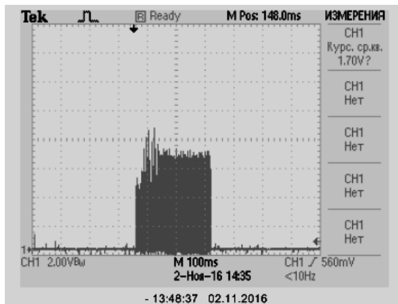
Рис. 3. Вихідна напруга (а) та струм через транзистори (б) напівмостового інвертора І1
