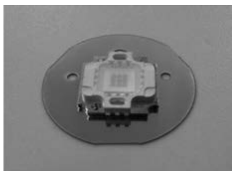
Рис. 1. Образец многокристального зеркализированного светодиода
