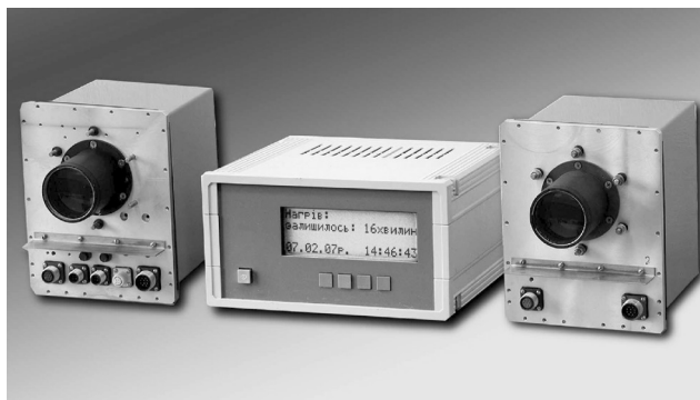
Рис. 2. Многокомпонентный газоанализатор 305ФА 02 (слева) и стационарный измеритель оптической плотности пылегазовой среды БОГ-1, входящие в систему автоматизированного контроля выбросов
