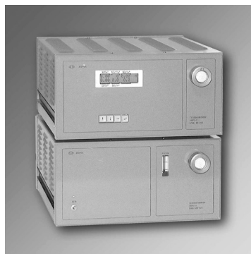
Рис. 2. Многокомпонентный газоанализатор 305ФА 02 (слева) и стационарный измеритель оптической плотности пылегазовой среды БОГ-1, входящие в систему автоматизированного контроля выбросов
