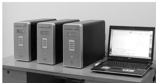
Рис. 3. Автоматические газоанализаторы 645XL 20, 667ФФ05, 621ЭХ20, входящие в систему мониторинга окружающей среды
